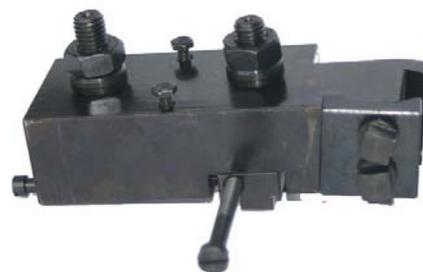
AS30/25 Stahlhalter für Schwalbenschwanzstähle auf Querschlitten Lage 1-2
