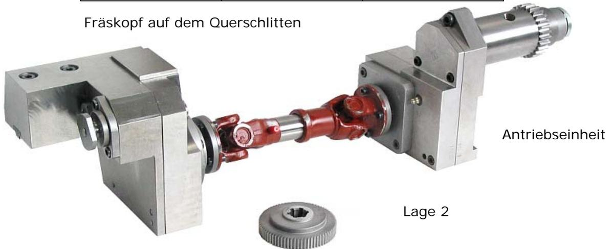
Das Verhältnis wird durch Wechseln des Räderpaars in der Antriebseinheit geändert. Die Einrichtung kann in Lage 2 oder 3 aufgebaut werden.
